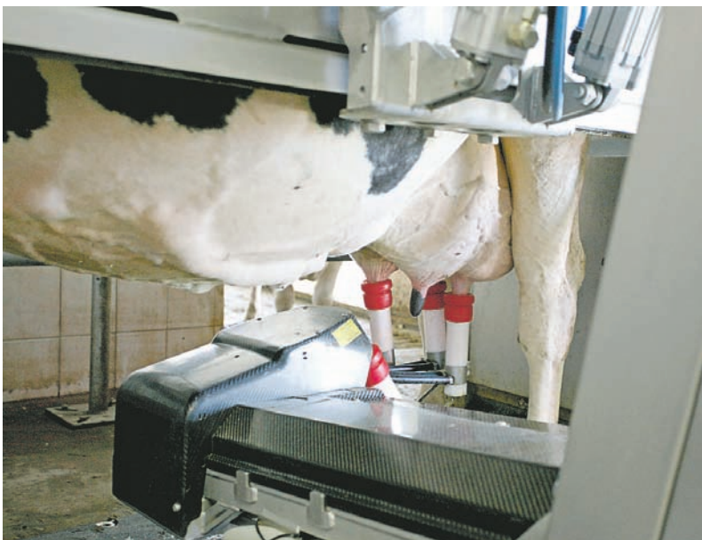
Alles vollautomatisch – der Melkroboter auf dem Buchackerhof in Betrieb.
