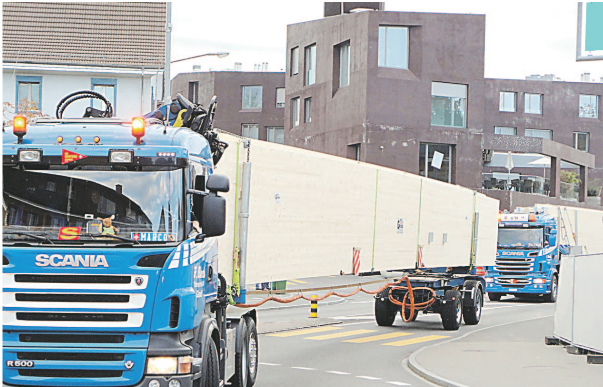
Mit Sondertransporten werden die Dachträger für die Dreifachturnhalle mitten durch das Dorf Sins angeliefert. Die Dimension passt sich ungewollt dem fast utopischen Hintergrund an.
